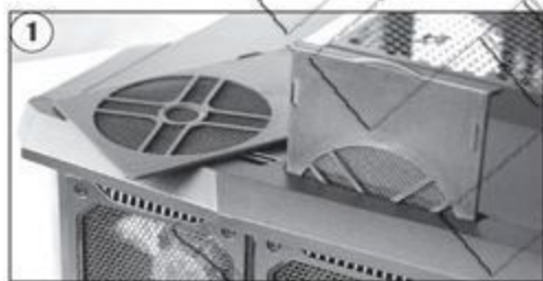
① 可抽取的防尘挡板
