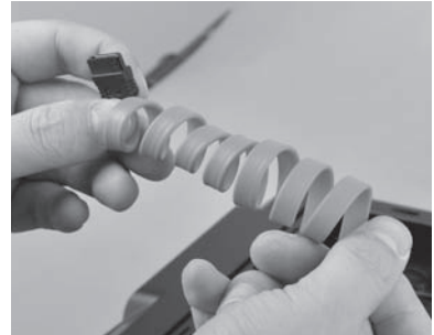
将SATA硬盘线卷曲成上图方式，可以有效管理线材的走线
