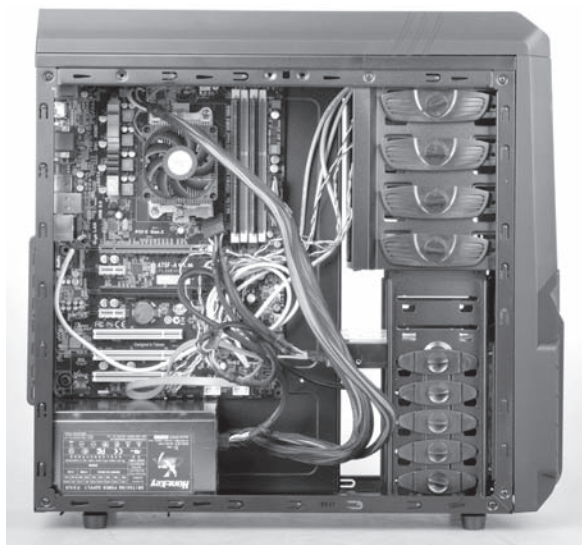
传统走线的机箱内部非常混乱影响风道
