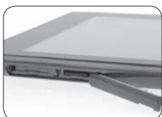
TF卡插槽外面还有防尘挡板
