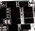
▲固态硬盘电路板上闪存芯片颗粒数越多(容量越大),写入速度越快
