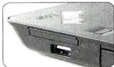
机身右侧黄色的USB接口支持关机充电，但必须在连接适配器时才有效
