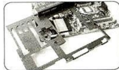
热敏护罩可以拆卸，通过背部螺丝固定
