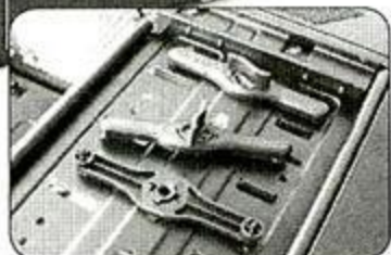
光驱和硬盘仓位采用了一体化架构, 通过免工具装卸的装置固定
