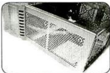
机箱顶部的散热孔，可惜没有独立的防尘网
