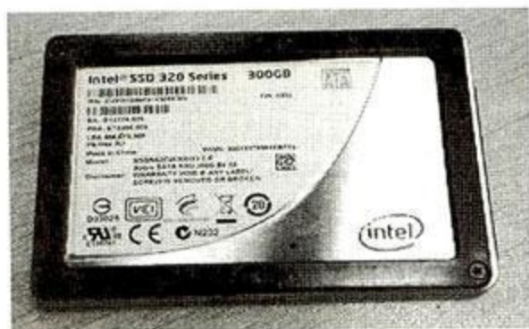
固态硬盘全貌，外面的黑圈可以取下，减少硬盘厚度
