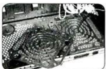
机箱底部的12cm风扇位，配有防尘过滤网
