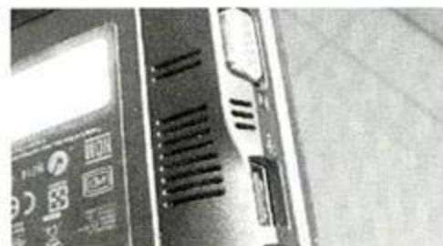
散热孔太小, 影响散热效果
