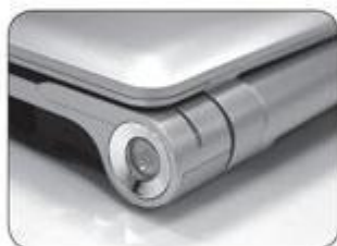
一体式圆柱形中轴设计
