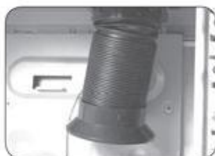
CPU独立风道有助超频散热
