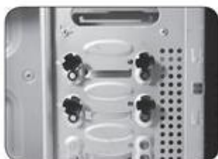
配合CPU风道散热的独立窗口
