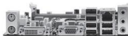
精英H61H2-M3除了DVI/VGA视频输出，还有USB 3.0作为卖点
