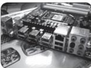
板载I/O接口部分,具备同轴输出和两组USB3.0
