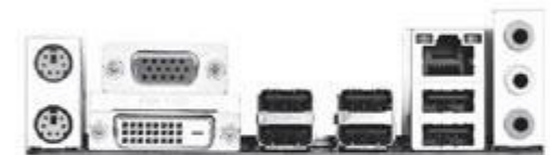
技嘉GA-H61M-D2P-B3的I/O接口为实用风格，有DVI/VGA视频输出
