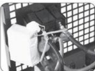
一级EMI滤波电路没有采用独立 PCB设计
