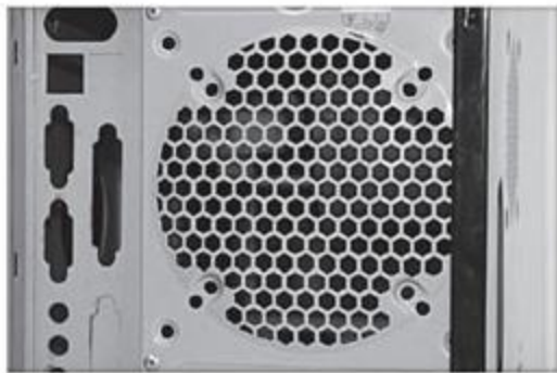
防辐射机箱散热孔设计科学合理，采用六边形，孔径在6mm以内
