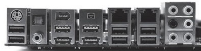
★新款主板会提供USB 3.0、e-SATA、光纤和多声道输出等完整的接口
