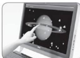
灵越2310采用了光学式多点触控屏幕
