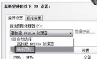
在NV控制面板的“全局设置”中可强制启动独显或者集显
