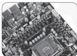
13项供电保障CPU稳定运行
