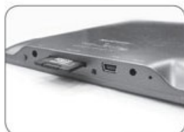
机身底部接口丰富, 可惜存储卡插槽没有防尘挡板
