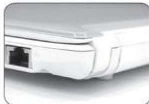
加厚电池可将底部翘起增强散热效果
