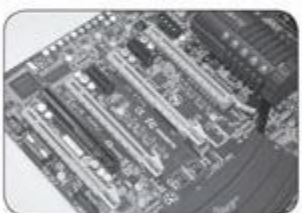
4条PCI-E插槽可提供4显卡SLI
