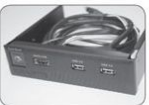
提供带有e-SATA、USB3.0接口前置面板
