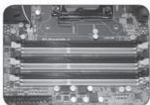
6 DIMM内存插槽支持DDR3 2133三通道配置
