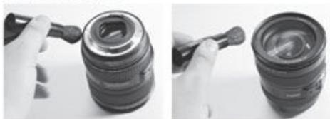
镜头的清洁和机身的清洁大同小异, 仍然是三步走, 第一步是气吹吹掉大的灰尘, 然后用毛刷刷掉较小的灰尘, 最后用镜头纸沾取镜头液进行由内而外的螺旋状擦拭。这里要注意的就是, 在到边缘的时候应当换为清洁棉签进行擦拭, 而不要用镜头纸进行擦拭。镜头的后组和前组一样, 也是同样的擦拭方法, 这里不在累述。值得注意的就是后面有金属触点, 大家可以用橡皮进行擦拭, 然后再用清洁棉签沾取清洁液进行擦拭。
