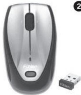
睡眠模式，以便在用户不使用电脑时，鼠标可自行节能，降低不必要的功耗施放。一般来说，省电的级别越多，对电量的微损耗就越小。以具备5级省电模式的富勒U15鼠标（图02）为例，正常工作状态下其电流是10mA，闲置1秒后降至4.4mA，再过1秒后则为1.3mA，然后依次为500 $\mu$ A、200 $\mu$ A、60 $\mu$ A，最后直至忽略不计进入睡眠。
