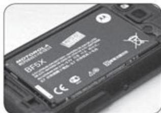
电池外有一圈橡胶材质防止水进入
