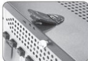
卡扣和手拧螺丝两种侧板拆装方式
