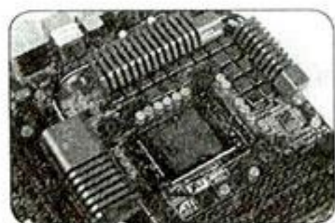
强劲的供电系统辅以散热效果极佳的散热片
