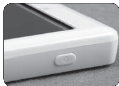
整个机器上只有一个按钮，它负责着开关机及返回功能
