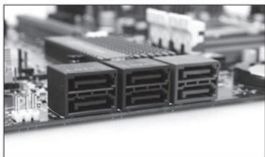
▲由于原生的6系列芯片组只支持两个SATA 6Gb/s接口, 此款主板6个接口中的剩下4个为SATA 3Gb/s。
