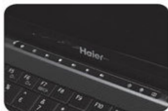
在C面（即键盘区）上方与屏轴结合处，有一排功能按钮，其采用触控方式
