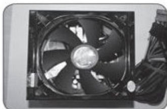
14厘米滚珠风扇, 散热性能好, 噪音低
