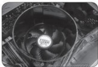
内部采用风筒散热，直连箱体侧板的散热孔，散热效果奇佳
