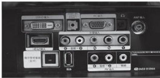
说到额外接口，我们第一个就会想到USB，USB接口是我们连接外设时最为常用的接口，无论是DC、DV、MP3、U盘、移动硬盘、外置刻录机等设备，USB接口都能派上用场，因此一些液晶产品也将USB接口设计到显示器其中。在液晶显示器上配备此项功能对于用户而言还是非常实用的，至少免除了弯腰在机型前面或后面寻找USB接口的痛苦，对于提高工作
