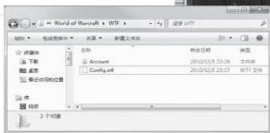
安装文件里的WTF文件夹,找到Config.wtf文件并用写字板打开,加入“SET processAffinityMask ‘X’”,如果是双核心CPU,这里的X改为3,因为3的二进制代码:11(1代表开启,0代表关闭)这意味着游戏使用前2个CPU。如果你的CPU是带有HT超线程技术的,那么请修改设置为5(二进制是101),如果你的CPU是物理四
