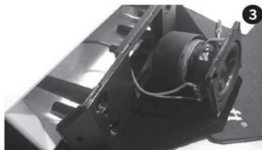
采用2英寸全频扬声器，据说M20采用了双磁体全对称屏蔽磁路系统，即在扬声器磁铁之上再加装一块磁体，其极性与主磁铁的极性相反，然后再用防磁屏蔽铁罩覆盖，这样既保证了音圈周围磁场的磁通密度高，又使磁场外泄极小。
