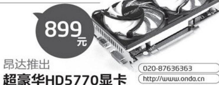
说到HD5770，广大玩家一定不会感到陌生。作为AMD高端显卡主力，HD5770一直是完美游戏速度的象征。随着GTS450的上市，HD5770的价格又开始了新一轮的调整。作为AMD国内最大合作伙伴之一的昂达电子，最近将其同芯片频率最高、做工最为奢华的HD5770神戈，降价至899元，性价比非常出色。该显卡使用RV840核心，拥有800个流处理器，完全支持最新的DX11规格。最为引人注目的是，凭借全固态电容做工、独立供电设计和超高速GDDR5显存，该显卡的工作频率达到了惊人的900/5000MHz，在所有的HD5770中是最快的。(李隆)
