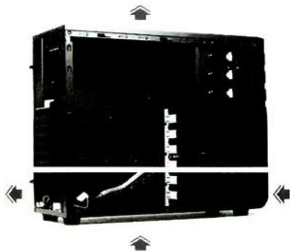
上为传统机箱、下为电源下置式机箱，热源分散价值独立风道结构，散热效果更为理想
