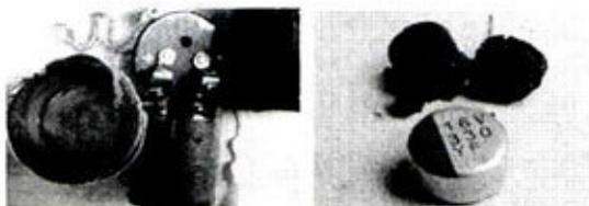
内部有液体的假固态电容很好分辨，顶部有“K”或“+”防爆槽。市场上XLL系列是仿真度较高，没有防爆槽的假固态电容。
