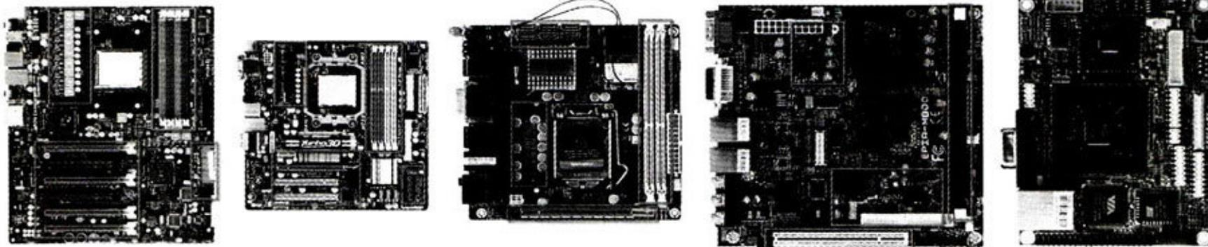
■各规格主板扩展槽图示，从左到右分别为ATX、MicroATX、MiniITX、NanoITX、Pico-ITX，FlexATX与BTX主板较为少见没有进行比较。
