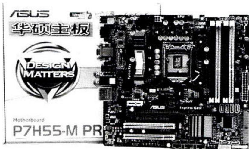
整体设计上，华硕P7H55-M Pro采用Micro ATX小板设计，基于Intel H55芯片组，采用摩卡色调PCB底板，整体定位风格依旧，它支持Intel的32nm的Clarkdale Core i5/i3/Pentium等LGA1156接口系列处理器。而且该主板还支持华硕GPU Boost技术，这项技术可以让GPU的性能有不少提升。P7H55-M Pro延续了华硕一贯扎实稳定的做工，在CPU供电方便该主板采用了4+1+1项供电设计，支持华硕的EPU节能技术，同时搭配了全固态电容，为i3提供强大的超频空间。该主板配备了4条DDR3内存插槽，最高支持DDR3 2133（超频）规格
