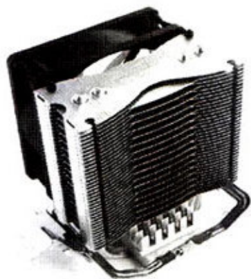
百叶窗式的散热片是为了增大散热面积，同时不增加体积、重量
