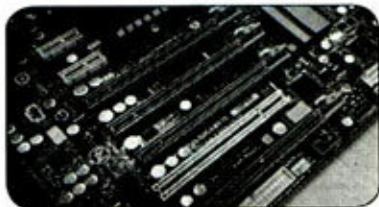
四条全场PCI-E接口, 多显卡实现起来很容易
