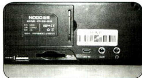
USB、读卡器等全部集中在音箱的背面。
