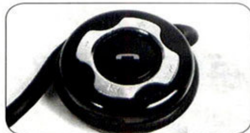
耳麦的一侧配有接通、音量、选曲等众多多功能键,十分方便
