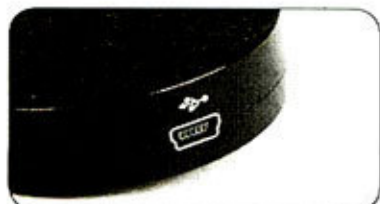
标准的mini USB充电接口, 通用性较高
