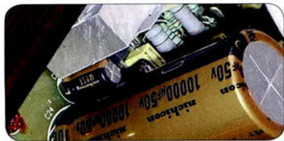
N45-G可谓猛料用尽，电源滤波多媒体音箱中少见的Nichicon 50V/10000 μ F电容
