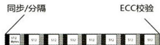
传统的格式化每512Byte便会出现一个同步/分隔和ECC校验部分
