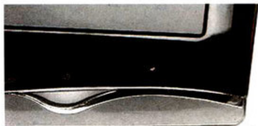
●主动光线感应并不会增加太多成本,右下方的一个小小传感器便可以动态调节显示器的亮度和功耗。
