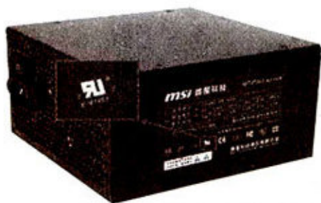
图中这款微星电源UL编号为E161451，使用网站查询得到CHANNEL WELL的结果，在Google中搜索CHANNEL WELL就可以知道这是侨威的产品。
