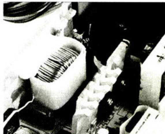
主动PFC控制芯片直接设计在PCB上，由两颗K3568距离主开关管，HEC 180uF 450V高压滤波电容，加CM6802SAHG主动PFC芯片组成，电能利用率方面表现更优秀。
