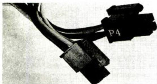
辅助电源接口方面多核R80配备了4+4pin的接口，无论是对于仅需单路+12V供电的普通主板亦或是供电需求旺盛的双路+12V高端主板均可得到很好的支持。
