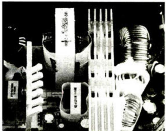
航嘉新版多核R80采用了两颗STP10NK60ZFP主开关管组成双管正激电路，黄色的变压器与铝制散热片都是航嘉产品成熟的方案，用户无需担心其品质。
