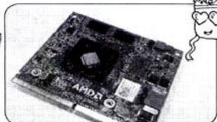
内部结构十分紧凑，独立显卡为特殊规格接口
