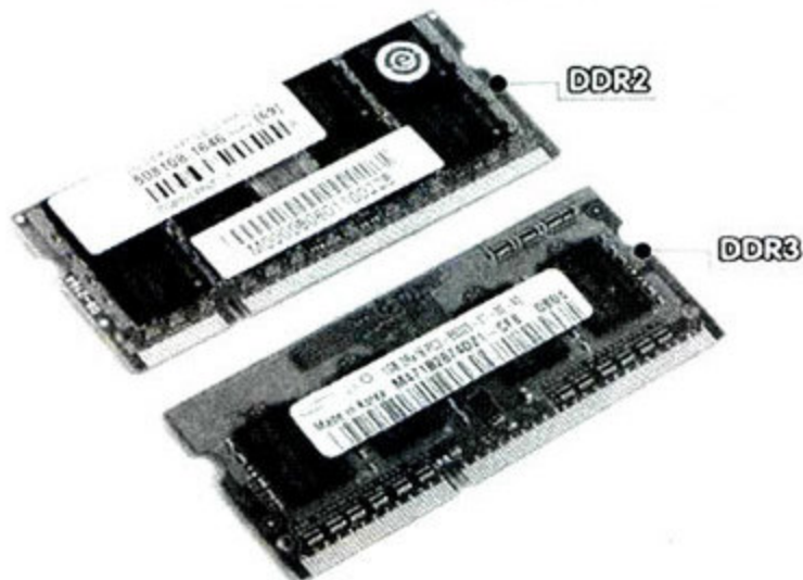
●区别DDR2和DDR3内存其实并不难，DDR3内存缺口更靠近中间，如果还分不清楚，看看标称电压就好了，DDR2内存电压为1.8V，DDR3内存则为1.5V。怎么样，简单吧？
