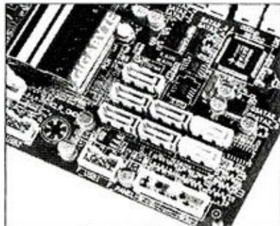
第三方磁盘控制器使得H55同样有支持RAID的能力, 并且提供了两个额外的SATA接口和一个额外的IDE接口
