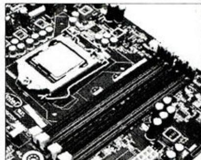
4条DIMM插槽,配有独立供电
