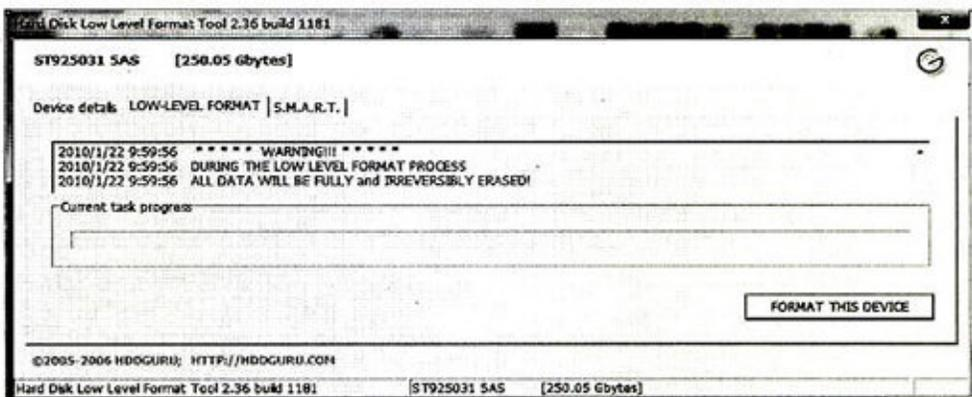
对面宿舍的小周过来帮忙检查,把笔记本硬盘拆了下来,告诉李群这个应该有办法解决。小周先将拆下来的笔记本硬盘装到一个移动硬盘盒里,然后连接电脑,下载了低格软件Low Level Format(下载地址: <http://tools.mydrivers.com/soft/424.htm>),运行程序选中USB磁盘设备并按下“Continue(继续)”按钮,注意此时务必不能选错,如果点选了主硬盘,是无法有效进行操作的。
