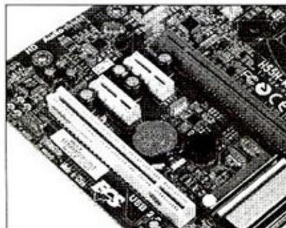
标准的扩展插槽设计,PCI-E ×16、2×PCI-E ×1,PCI样样不缺
