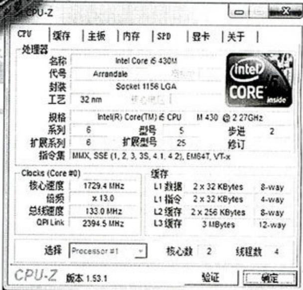
2.26GHz的频率最高还能根据使用需求自动提升频率
