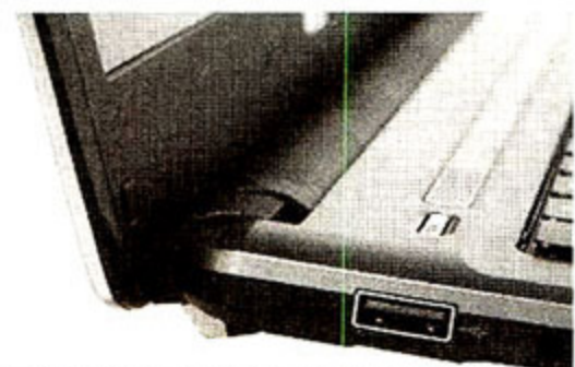
▲屏轴采用下沉式设计,顶盖开合角度越为160度,足够日常使用了。别看那纤薄的LED背光屏幕好似弱不禁风,其实,它的顶盖采用合金材质的原因也在于此——充分保护屏幕,具有相当好的抗压性
