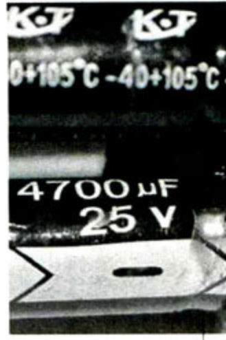
▲滤波电容采用了连腾电子的25V 4700µF的电容，就容量上绰绰有余，一般我们认为超过2000µF就已经是不错的用料了。
