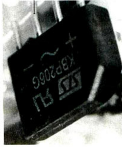
▲STS KBP206G，整流桥堆，主要作用是整流，调整电流方向。用料中规中矩，虽不奢华，但是足够扎实。接副音箱的金银线，有着耐腐蚀抗氧化的作用。
