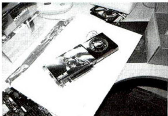
▲采用GT200b核心的华硕ENGTX285效率频率达到602MHz/1269MHz/1107MHz(核心/SP/显存),在RV870(HD5870)未发布前单卡卡皇无出其右。
