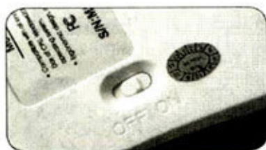
鼠标底部独立的电源开关
