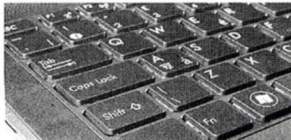
▲键帽的尺寸很大，巧克力键盘也让键距进一步拉大，敲击时基本不存在误触的情况，敲击时手感也非常舒适，键程适中
