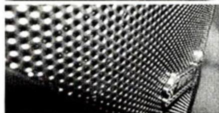
▲机箱背面的8cm静音风扇, 与前面板下部的12cm风扇配合保证了前进后出的畅通风道设计, 并且因设计合理的散热孔大小并未造成箱内辐射的泄露。
