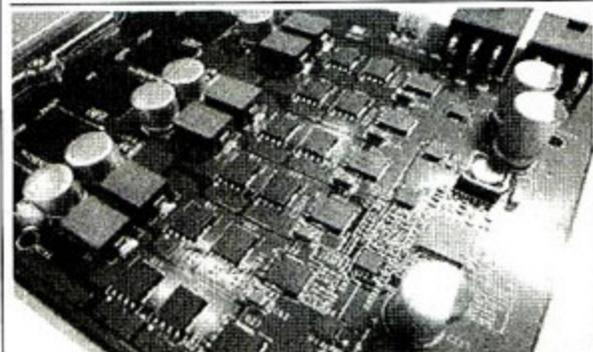
▲显卡供电部分采用6+2相供电设计,相比GTX280显卡使用的5+2相供电加强了对核心供电能力,为提升核心频率打下了扎实的基础。
