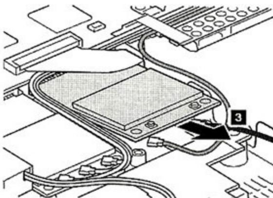
· 预留有SIM插槽的机型，都会在机身内预留有Mini PCI-E安装槽位，它的接口规格与WiFi无线网卡所使用的接口规格一致，绝大多数具备3G网络扩展的本本，都可以通过拆除背板的方式将3G模块安装进去，安装的时候，将3G模块以30度斜角插入插槽，然后对外端两侧施加向下的压力，听到“咔”的一声，就说明安装到位了。
