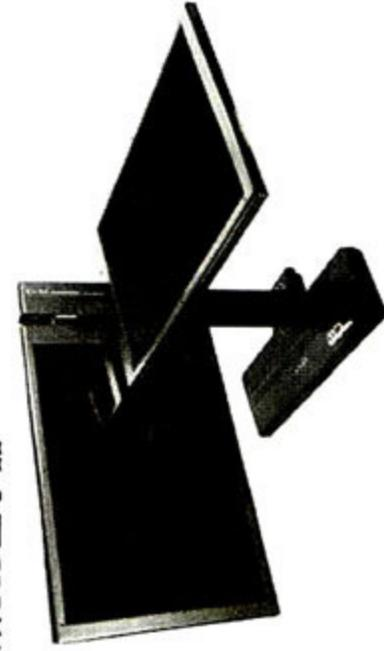
板卡业制造商EVGA7月16日公布了一款LCD产品InterView 1770。它由两块17英寸LCD组成，都可以180度旋转，可以形成多面多角度甚至显示茶几桌面的效果。两台显示器的分辨率均达到1440×900，并内置一个130万像素的摄像头以及3个USB接口。对比度和亮度分别是500:1和220cd/m<sup>2</sup>，售价650美元。
