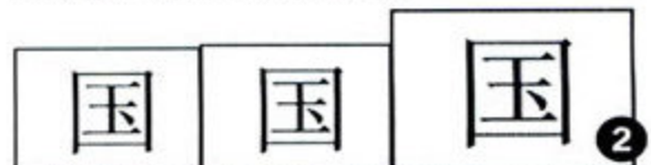
● 不同点距液晶显示器显示的字体大小,从左到右依次为0.255mm、0.258mm、0.294mm。
