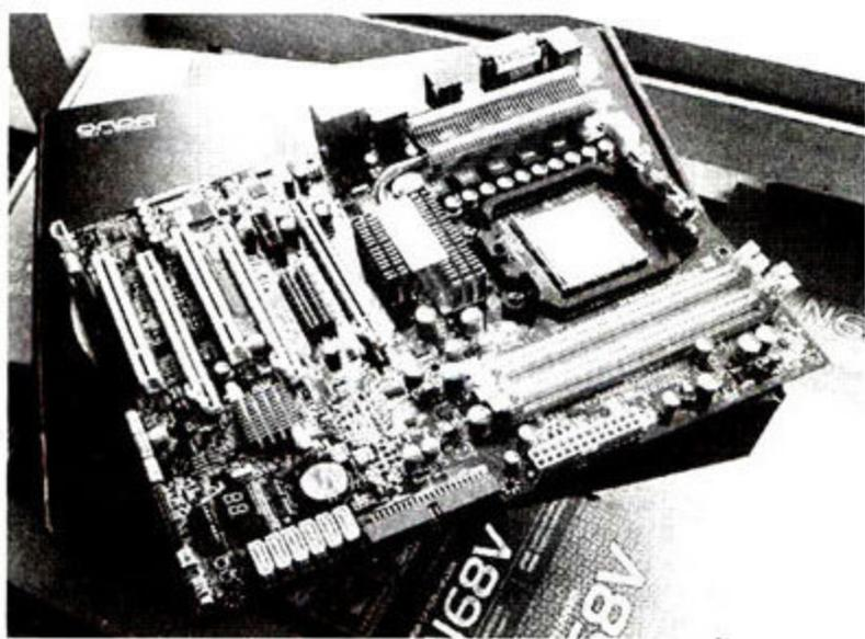
高达900MHz了。从A78GT/128M开始,昂达的SidePort显存技术通过先后推出的9款BIOS已逐步调整成熟,而在支持DDR3显存之后,魔剑A790GX+甚至比8500GT独显的表现还要强,尤其是面对《使命召唤5》这类人纹理运算量的游戏时,它带来的性能提升更加明显。这样强悍的规格,搭配“Hybrid Plus”混合内存技术,确实解决了很多近期装机朋友的实际顾虑。有这样一片主板,至少能保用5年不落伍了。(李隆)
