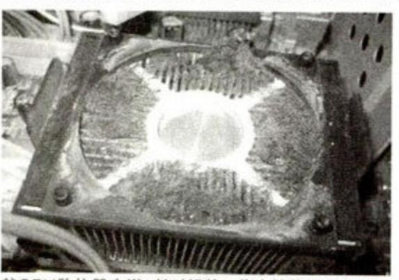
就CPU散热器来说, 长时间的工作在散热器鳍片上积聚着大量的灰尘, 非常不利于CPU散热, 所以很多电脑看似散热风扇在转着工作, 但电脑经常会死机, 当用手去触摸散热鳍片时, 会非常烫手, 甚至不感去触摸它。这就是灰尘的危害!
