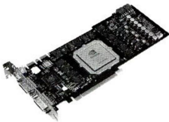
从实物图我们可以看到Geforce GTX285上最明显的改进在于将16颗显存全部布线在PCB正面，而Geforce GTX280则是平均分布在PCB的正反面，新设计的好处在于简化布线，因此Geforce GTX285的PCB只有10层板，而Geforce GTX280采用的P651 PCB是14层PCB设计，用发烧友的话来说“YY度”有所降低。
