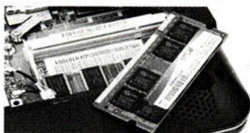
将内存以45度角斜插入内存插槽,注意对准那个“缺口”,推到位后向下压内存,两侧的金属卡扣会自动“卡住”内存
