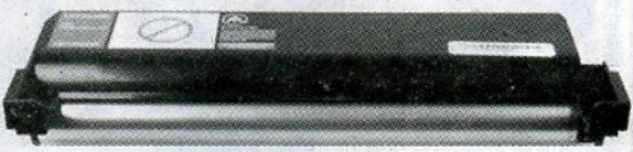
我们要擦拭的部分就是硒鼓中那个光滑的圆柱状的东东,也就是“鼓芯”
