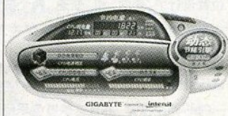
▲采用2相供电时，动态节能的配套管理软件还能够显示目前CPU的耗电量情况，很是实用
