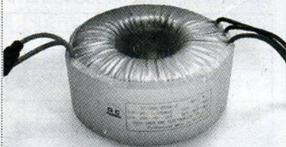
▲ 大功率变压器通常采用环形结构, 俗称为“环牛”, 相同重量的环牛, 它的功率比普通变压器要高很多, 但是由于制造工艺成本较高, 导致环牛的价格也不菲。
