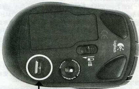
多数无线鼠标底部具有电源开关，不用时可以关闭
