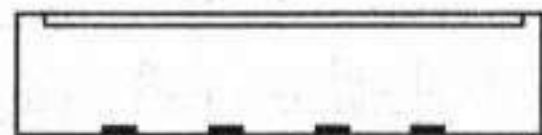
▲USB接口切面示意图 1: +5V 电源 2: 数据- 3: 数据+ 4: 地线
