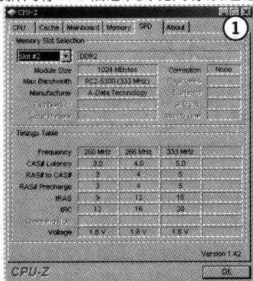
▲“内存时序”是内存的重要参数, 调整不同的“内存时序”会影响内存的运行速度及系统的稳定性, 在对电脑超频时也需要修改这些参数
