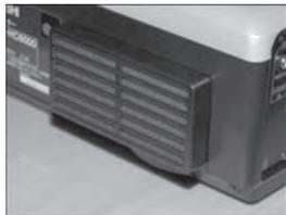
答：首先，投影画面上出现脏点，说明该投影仪液晶板上存在灰尘，建议你找专业人士进行清洁，一般问题可以解决。另外，投影仪工作很短时间，就出现温度指示灯变为红色，投影仪会自动停机的现象，可能是由于空气滤清器灰尘过多导致温度过热，可以尝试清洗或者空气过滤器，一般问题可以解决。清洁空气过滤器需要专业人员进行。有些投影机还必须把空气过滤器使用时间进行复位，不然的话将会影响投影机的正常使用。
