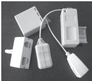
有的电话线上获得最大的数据传输能力，这样用户在一条电话线上既可以上网快速“冲浪”，还可以打电话发送传真，而不影响通话或降低Internet的速度。但是这有一个通道分离的问题，只有把相应的信号分配给ADSL Modem才能够识别和工作。经过编码后的混合信号通过电话线传到家庭
