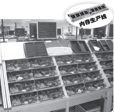
▲内存的PCB板，这些PCB板都准备着安装内存颗粒(就是内存上的集成电路)
