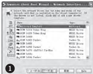
进入网卡类型选择界面(见图1)，根据自己的网卡可以从中选择相应的网卡型号，如果这里没有找到你的网卡驱动，可以单击左侧“Add”按钮，添加我们需要的网卡驱动。找到合适的网卡驱动后，单击“Next”。
