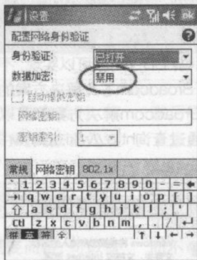
身份验证部分选择“已共享”, 数据加密部分设置为“WEP”, 同时下面输入路由器中预设的密钥即可。
