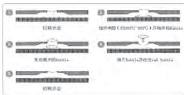
▲ 气泡式打印机喷嘴工作原理及工作流程示意图
