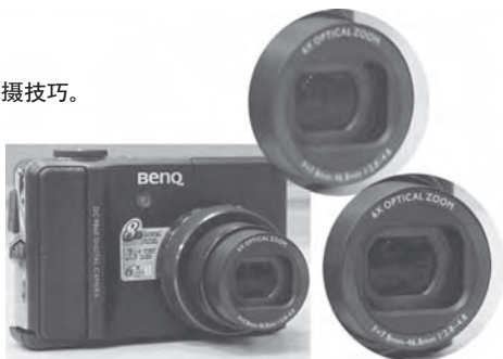
光圈F2.8时，机身上的字清楚，但镜头的字模糊 光圈F11时，机身和镜头上的字迹都很清楚
