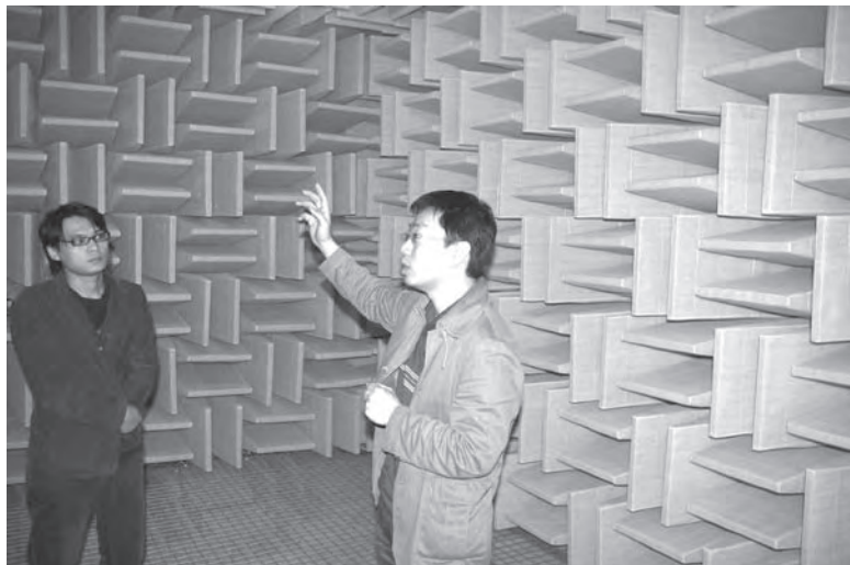
▲三诺电声总监张谦介绍消声室指标情况。消声室为音箱的声音调试创造了有利的条件。
