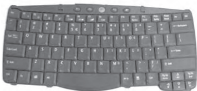
▲ 拆卸下的键盘
