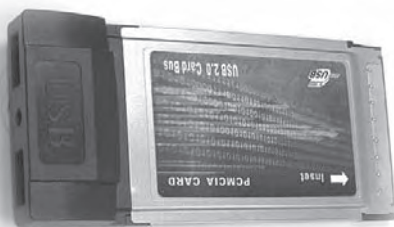
加装PCMCIA USB 2.0卡很简单，但最好不要热插拔使用，一般这个接口都在笔记本的左侧
